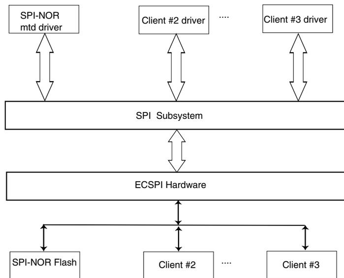
**Figure 32-1. SPI Subsystem**
